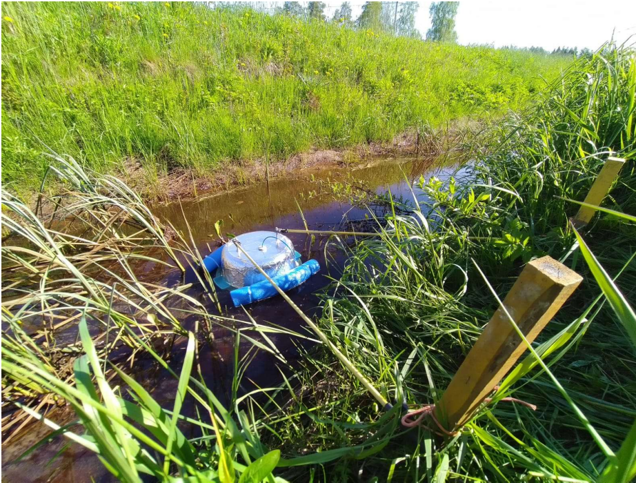
Kuva 7. Kasvihuonekaasumittaukset Ruukin tutkimuskentän avo-ojista kelluvilla kammioilla. Kuva: Miika Läpikivi, Oulun yliopisto.
