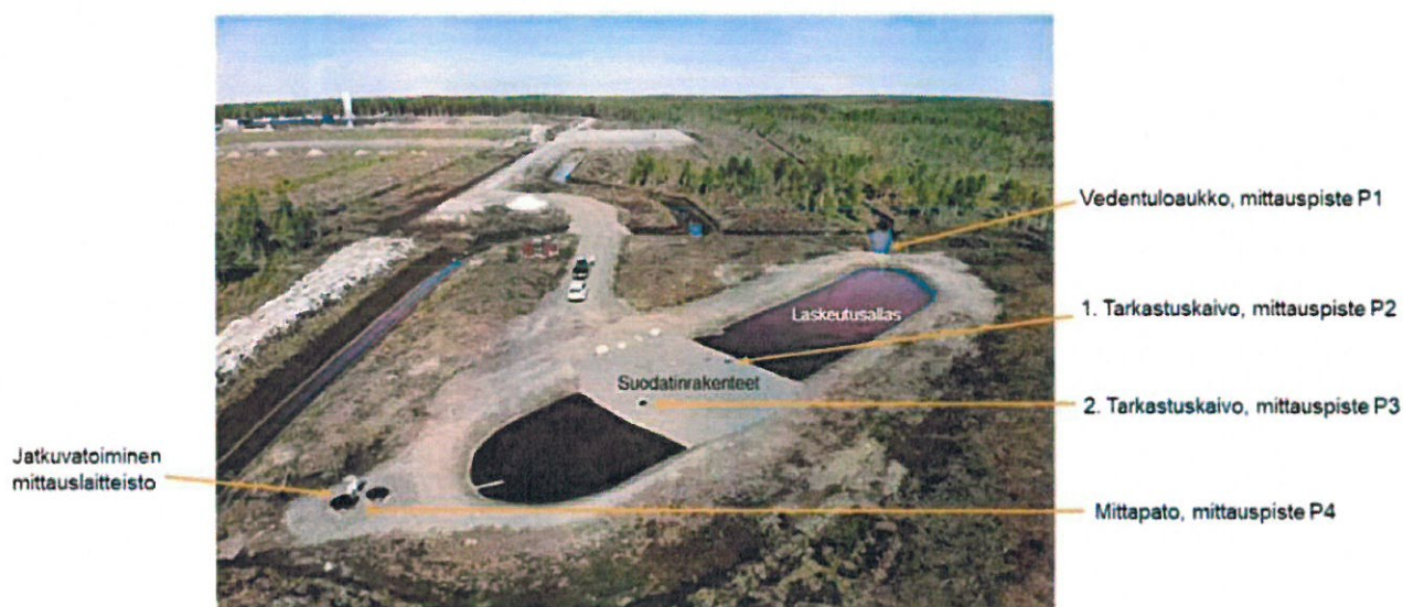
Kuva 2. Vesiensuojelurakenteen näytteenottopisteet (AFRY 2022, alkup. ilmakuva Sirviö et al. 2010)
