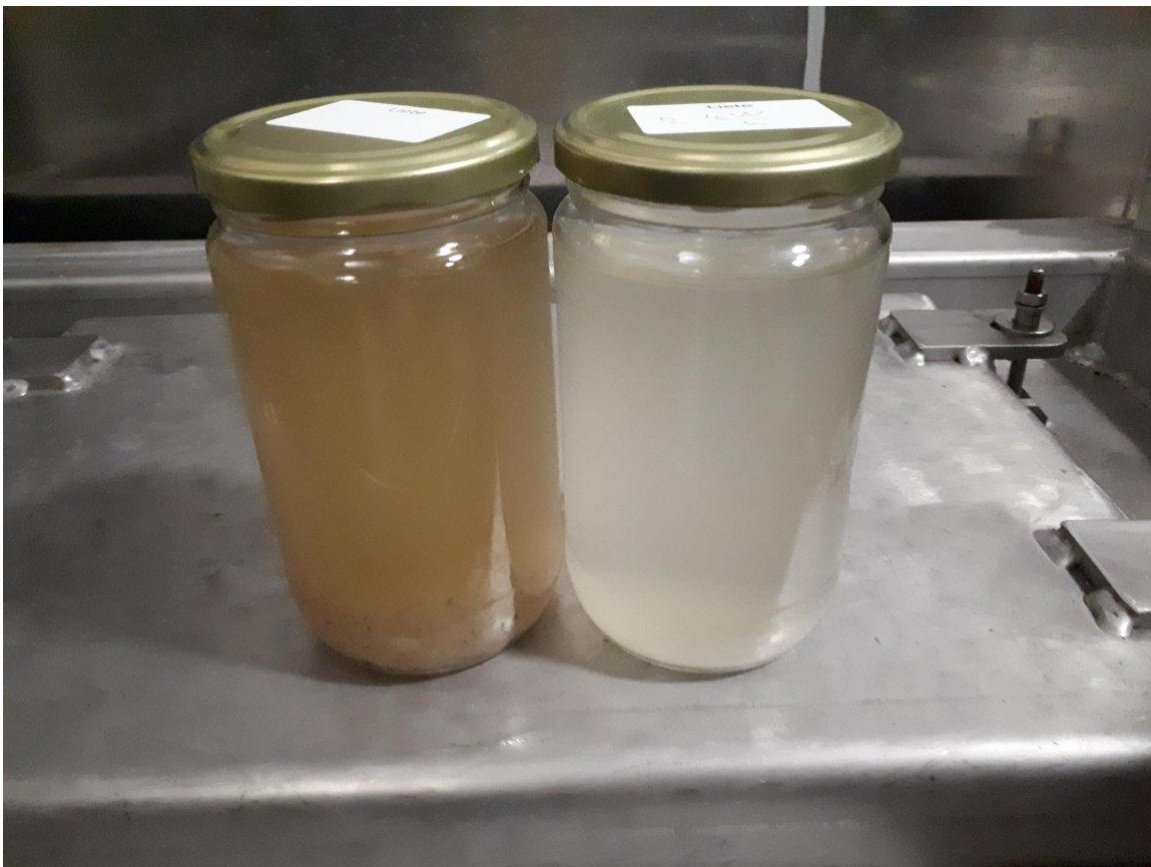
Kuva 3. Käsittelemätön (vas.) ja käsitelty (oik.) jätevesinäyte. Käsitelty näyte on käsitelty 2 \text{ kWh}/\text{m}^3 ominaisplasmaenergia-annoksella.
