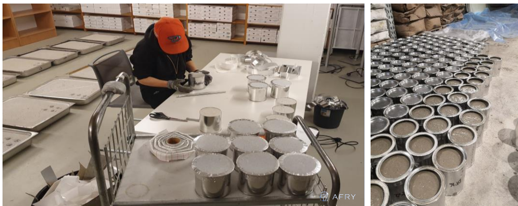
Kuva 2. Kokeellista osuutta varten valmistettiin n. 1500 koekappaletta, joista selvitettiin mm. erilaisten betonien kemiallista kuivumista ja kosteuden haihtumisnopeutta sekä päällysteiden vaikutusta kosteuden uudelleen jakautumiseen.
