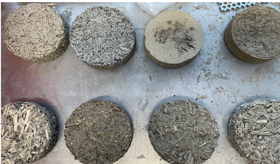
Akustiikkalevymateriaalin koekappaleita. Saven mikrohuokosilla on merkittävä rooli seoksen akustisesti vaimentaviin ominaisuuksiin. Hankkeessa kokeiltiin lisäksi eri kasvikuuduilla ja mineraalisilla täyteaineilla. Alustavien testien tulokset olivat lupaavia.
