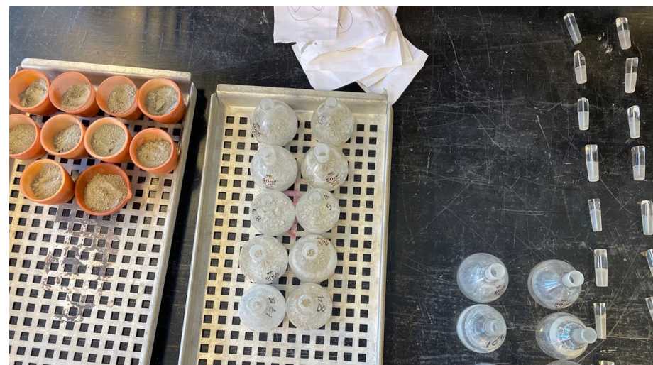
Maalaboratorion välineistöä: vasemmalla humuspitoisuuden selvittämisessä käytettävät poltto-astiat, oikealla kiintotiheyden määrittämisessä käytettävät pyknometripulloja.
