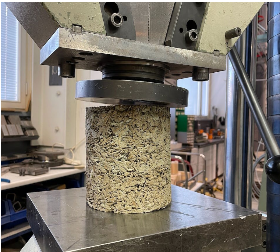
Puristuslujuuden testausta Rakennustekniikan laboratoriossa
