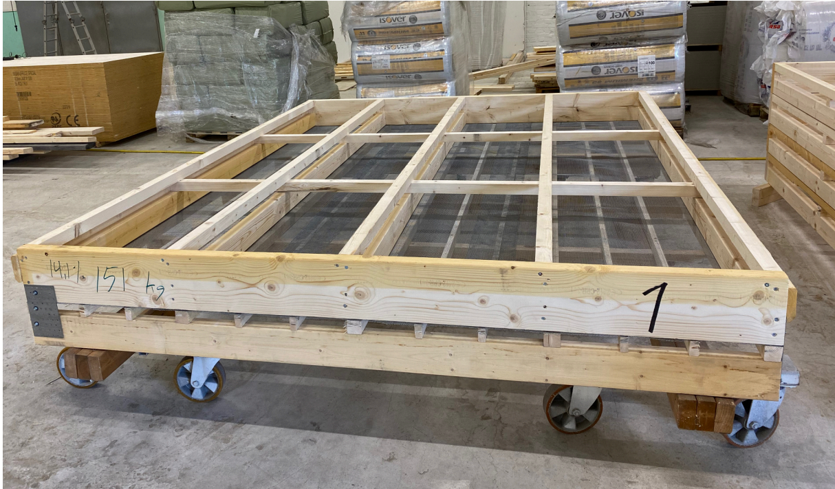
Kuva 3: Prototyypielementti kuivaustelineen päällä. Kuivaustelineen verkko toimii muottina savimassan sullomiselle.
