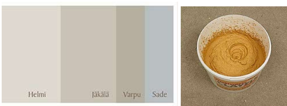
Kuva 14. Esimerkki perinnemaalien sävykortista vas. (Uula Color) ja savipinnoitteesta kosteana oik. (Claytec).
