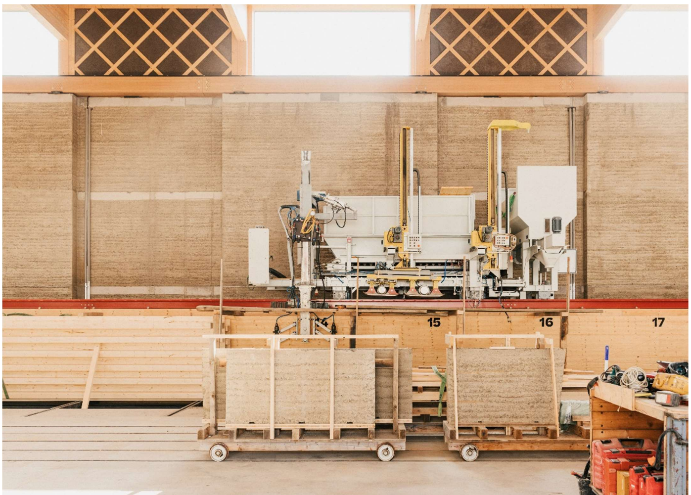
Lehm Ton Erde Baukunstin massiivisavielementtien teollinen tuotanto [3]
