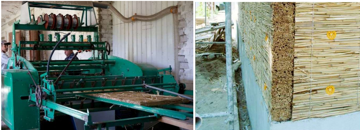
Kuva 9. Ruokolevyn ja -maton valmistusta vas. (SaviUKUmaja) ja levyn käyttö kivitalon lämmöneristeenä oik. (Hiss Reet).
