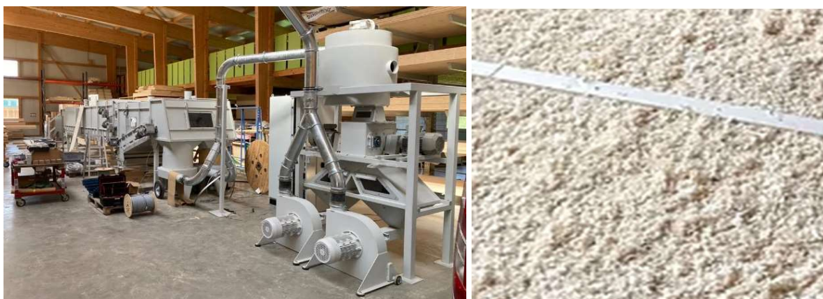
Kuva 7. Puhalluseristeen tuotantolinja vas. (Iso-Stroh) ja eristetty välipohja oik. (Ehta Talot).
