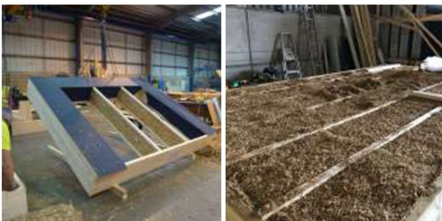
Elementtien vaakasuuntainen valmistus ModCellin tuotantotiloissa [2]
