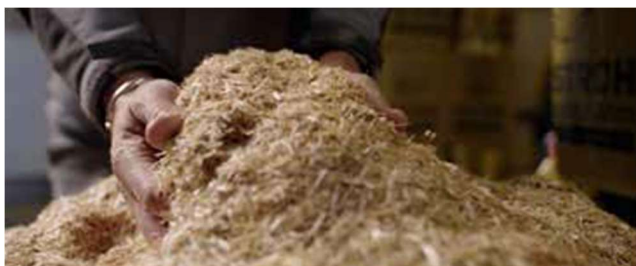
ISO-Strohn valmistamaa puhalluseristettä oljesta [2]
