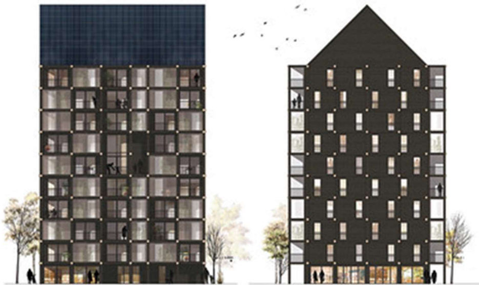
Kuva 29. Strombro Building Workshop AB on saanut rakennusluvan Ruotsin Malmöön rakennetavalle 12 kerroksiselle vuokra-asuintalolle, joka koostuu olkielementeistä ja kantavasta CLT-rungosta.
