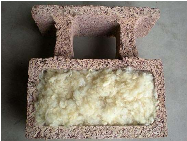
Isolan irtovillaa puu-betonihiharkkojen eristeenä [1]
