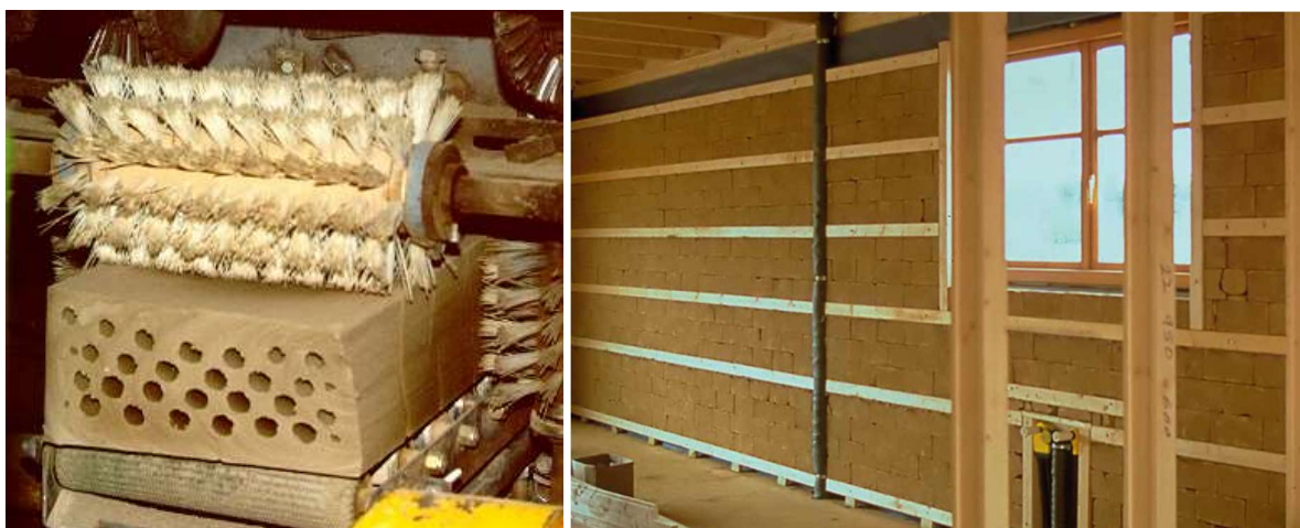
Kuva 13. Tiilen valmistusta suulakepuristamalla vas. (Seppälä) ja käyttöä polttamattomana seinän lämpö- ja kosteuskapasiteetin parantajana oik. (Dachverband Lehm).
