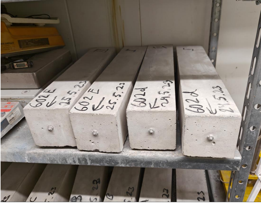
Kuva 13 Palkit vähähiilisen betonin kutistumismittaukseen.
