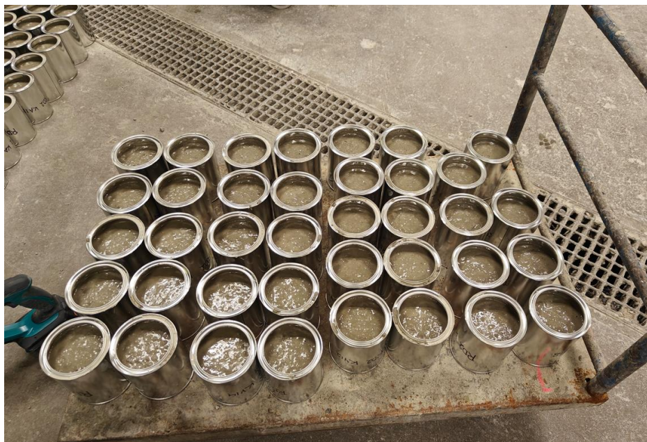
Kuva 11 Koekappaleita betonin kemiallisen kuivumisen selvittämiseksi.
