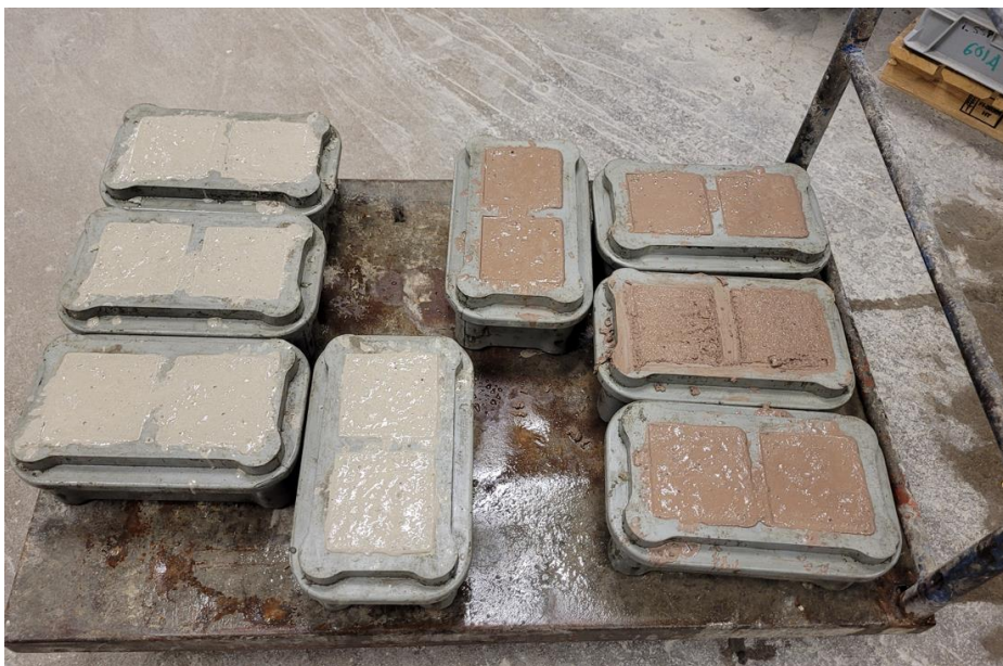
Kuva 10 Koekappaleita muoteissa puristuslujuuden mittausta varten.
