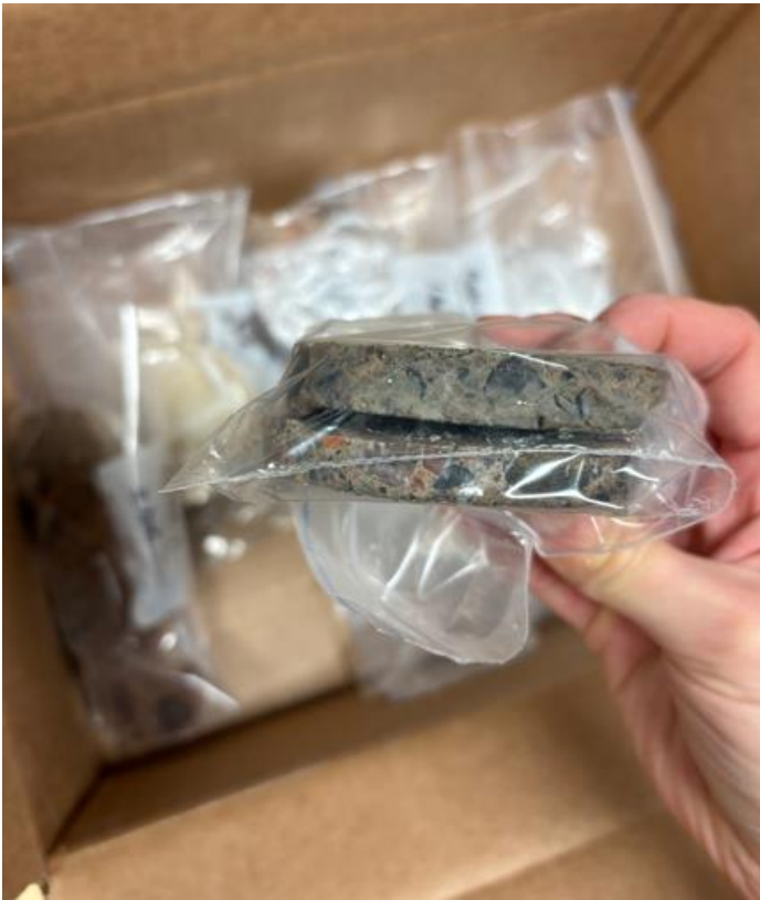
Kuva 5 Porakappaleista sahatut näytteet hiilensidonnan määrittämiseen.
