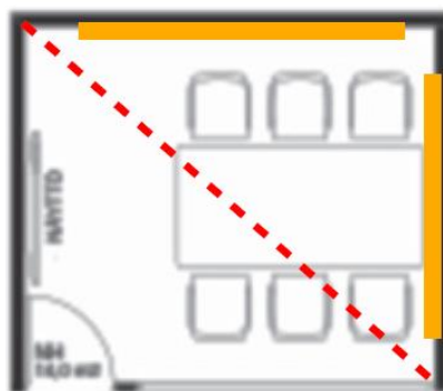
Kuva 2. Vaimennuspintojen sijoittelu neuvotteluhuoneessa / esimerkkiratkaisu 1. (Pohjalla oleva kuva: Valtion työympäristöjen suunnitteluohje / Workspace Oy)
